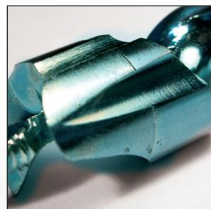
El cabezal de perforación escalonado hueco logra una fricción total menor durante la perforación a través de la propagación de calor. La broca ELITE está expuesta a un esfuerzo muy bajo detrás del cabezal de perforación escalonado. Esto permite un flujo de virutas eficaz, también en perforaciones extremadamente profundas. Se recomiendan velocidades de rotación mayores que las utilizadas en las brocas de espiral normales.
